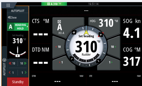
Simrad MFD arbeitet mit unserem Autopilot Autopilot eingebautes Kontroll Panel (web)
